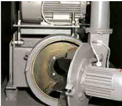
Wanner E45.80 entegre fanlı, siklon separatörlü ve toz alma sistemli. ➤
