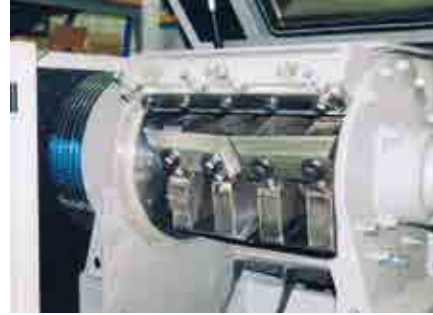
V şekilli rotora sahip geniş kesme haznesine kolayca erişilebilir.
