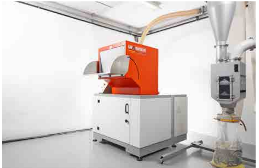
Wanner E45.80 entegre fanlı, siklon separatörlü ve toz alma sistemli. ➤
